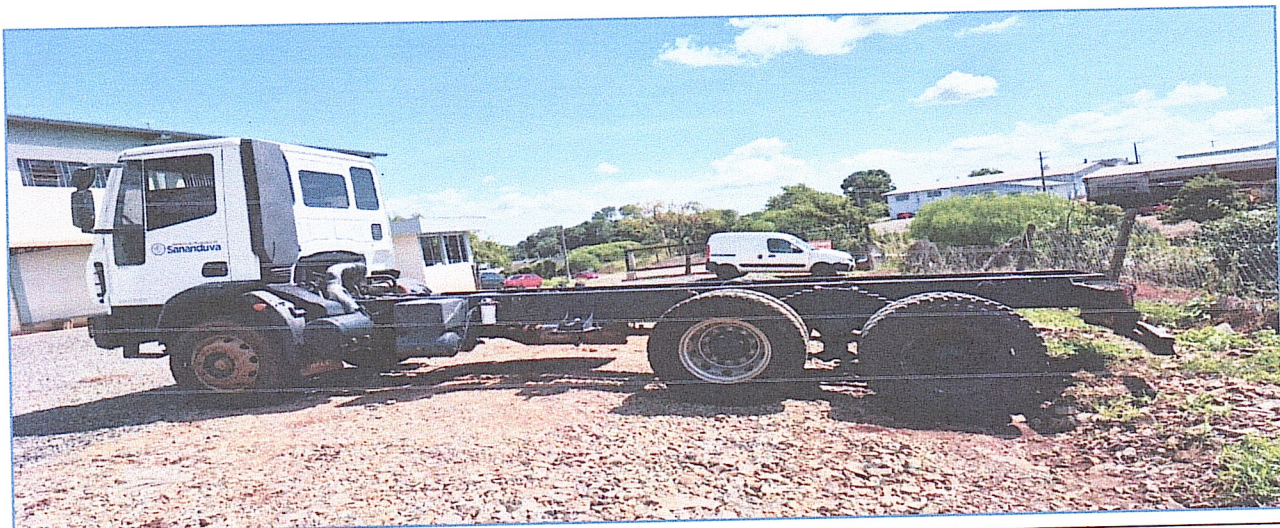
Imagem do Caminhão Iveco (Placa JBG5J48) que deverá ter seu chassi consertado e instalado caçamba basculante NOVA com capacidade de 15 m 3 para rochas
