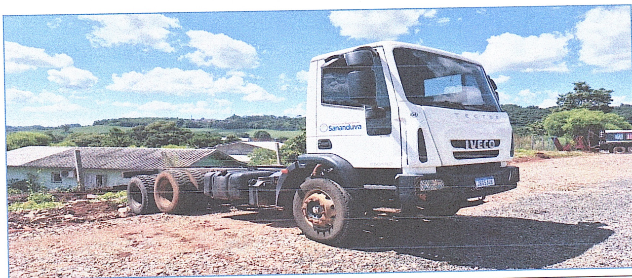
Imagem do Caminhão Iveco (Placa JBG5J48) que deverá ter seu chassi consertado e instalado caçamba basculante NOVA com capacidade de 15 m 3 para rochas
