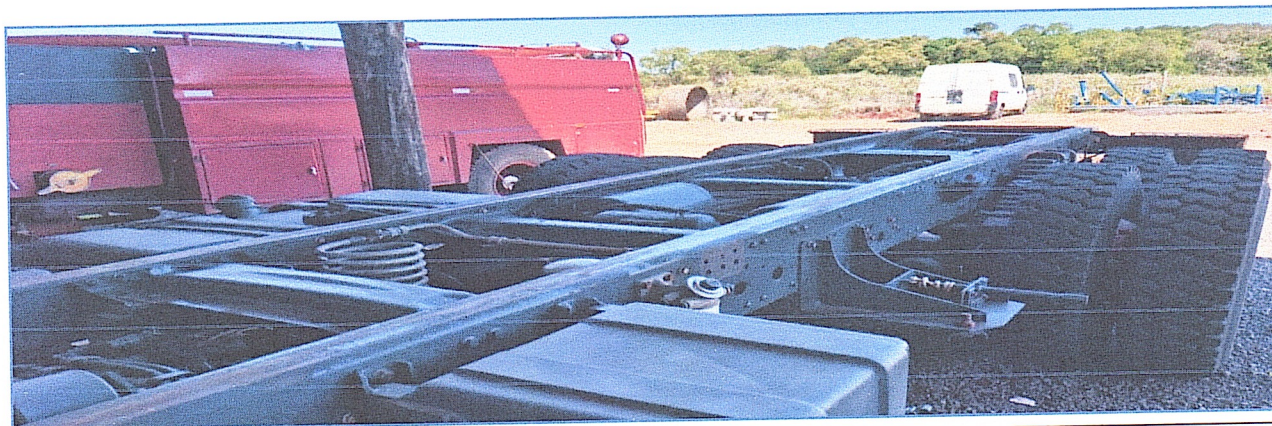
Imagem do Caminhão Iveco (Placa JBG5J48) que deverá ter seu chassi consertado e instalado caçamba basculante NOVA com capacidade de 15 m 3 para rochas
