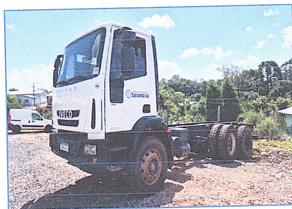
Imagens do Caminhão Iveco (Placa JBG5J48) que deverá ter seu chassi consertado e instalado caçamba basculante NOVA com capacidade de 15 m 3 para rochas
