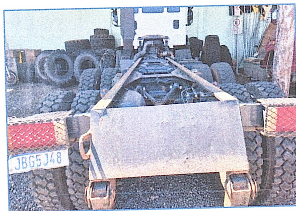
Imagens do Caminhão Iveco (Placa JBG5J48) que deverá ter seu chassi consertado e instalado caçamba basculante NOVA com capacidade de 15 m 3 para rochas
